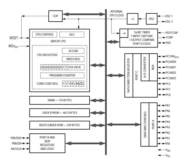
Figure 1-1. MC68HC705P6A Block Diagram
